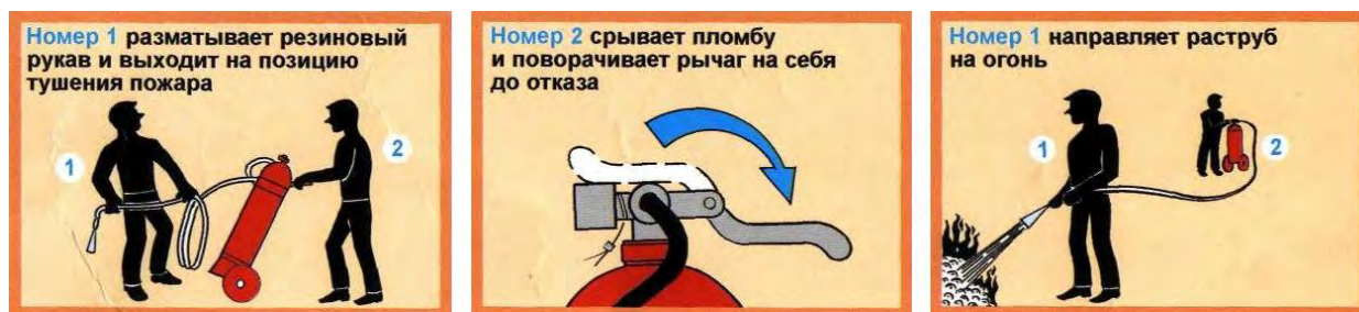
Рис. 3.13. Приведение в действие передвижного углекислотного огнетушителя
