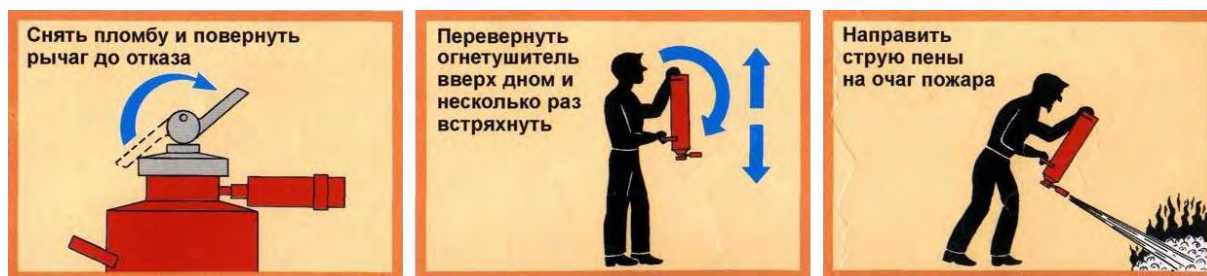
Рис. 3.17. Приведение в действие химического пенного огнетушителя
