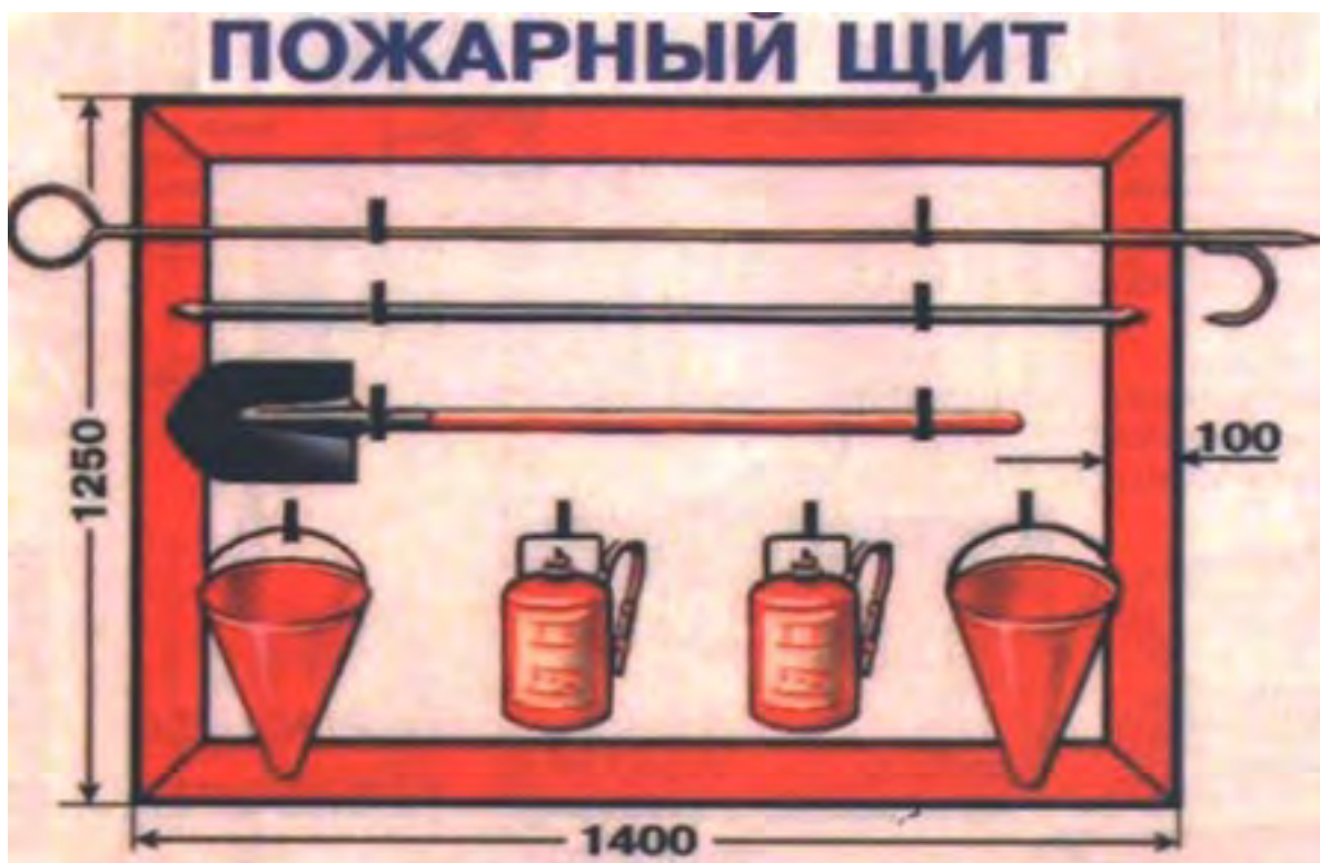
Рис. 3.4. Внешний вид пожарного щита
