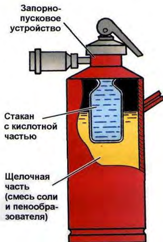
Рис. 3.16. Внутреннее строение химических пенных огнетушителей
