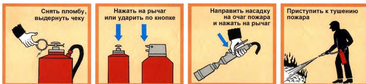
Рис.3.19. Приведение в действие воздушно-пенного огнетушителя
