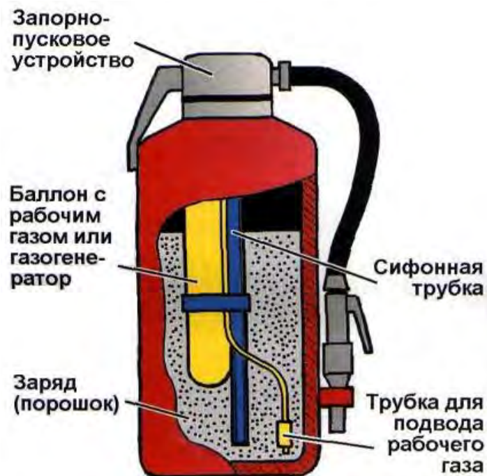
Рис. 3.22. Внутреннее строение порошкового огнетушителя со встроенными газовыми источниками давления
