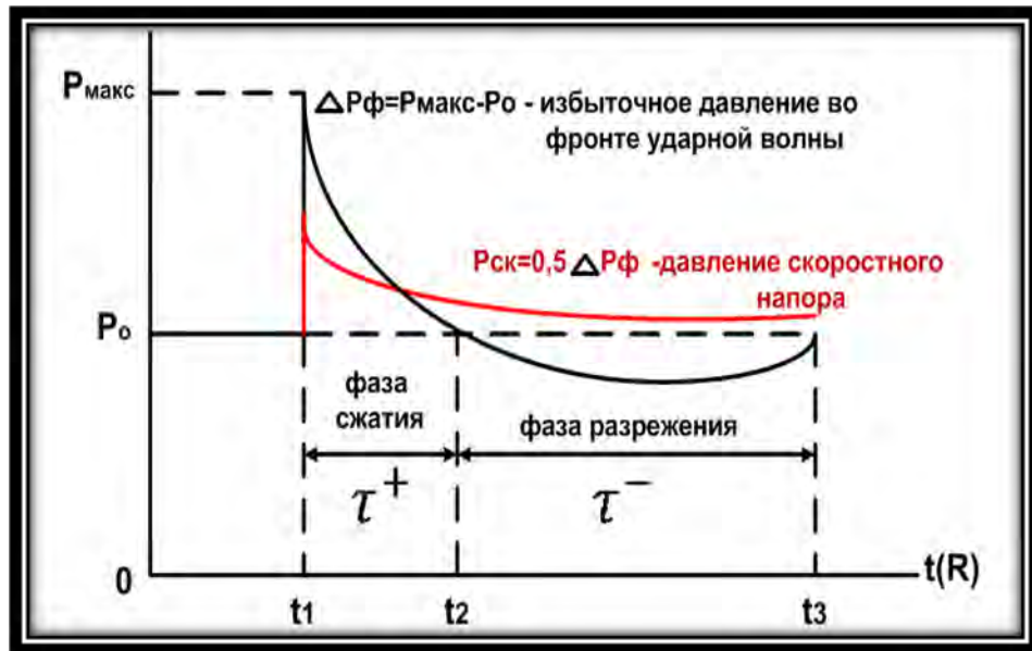
Рис. 3.1. Параметры воздушной ударной волны
