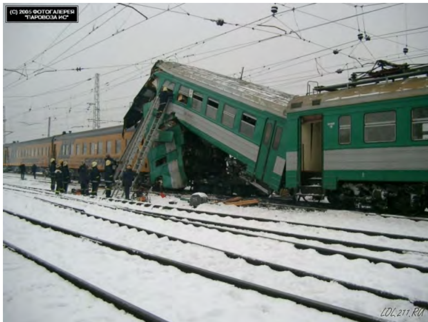
Рис. 5.1. Авария электрички из-за неисправности железнодорожного пути
