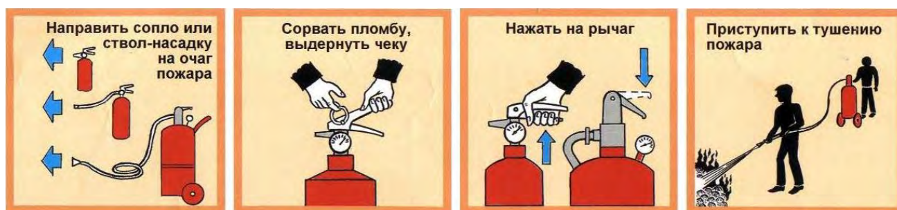
Рис. 3.25. Приведение в действие закачного огнетушителя
