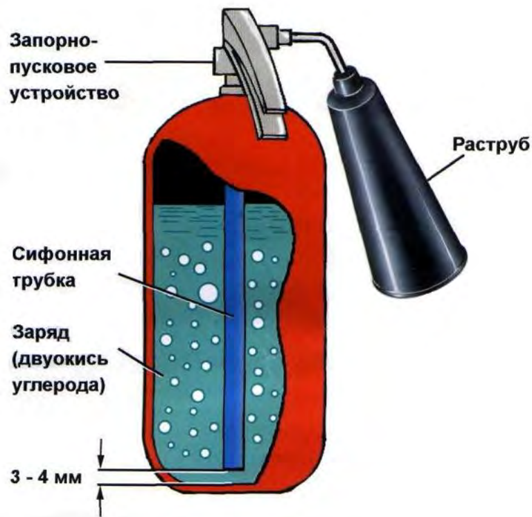
Рис. 3.9. Внутреннее строение углекислотных огнетушителей
