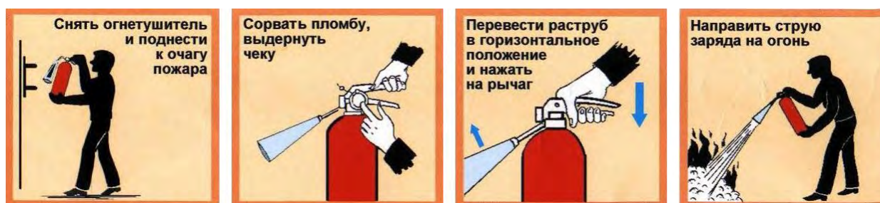
Рис. 3.12. Приведение в действие ручного углекислотного огнетушителя
